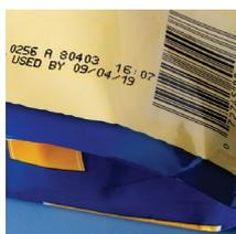
BOPP, HDPE, PE, PVC, PP, PET, acrílico, ABS, poliestireno e filme de polietileno tratado podem apresentar desafios quanto à aderência da tinta devido às propriedades inerentes da superfície "lisa" e ao uso de diversos plastificantes. A formulação das tintas plásticas/filmes flexíveis da Videojet concentra-se nos mais resistentes desses materiais para oferecer máxima aderência e durabilidade do código.
